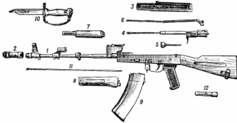
Рис. 7 АК-74 (неполная разборка автомата)
